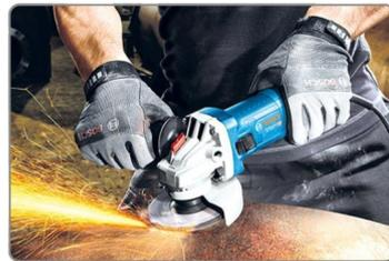
**粗磨:** 用“角磨机”更换砂纸将预处理过的部位, 按照从粗到细的粒度对检测试验进行粗磨、精磨;
